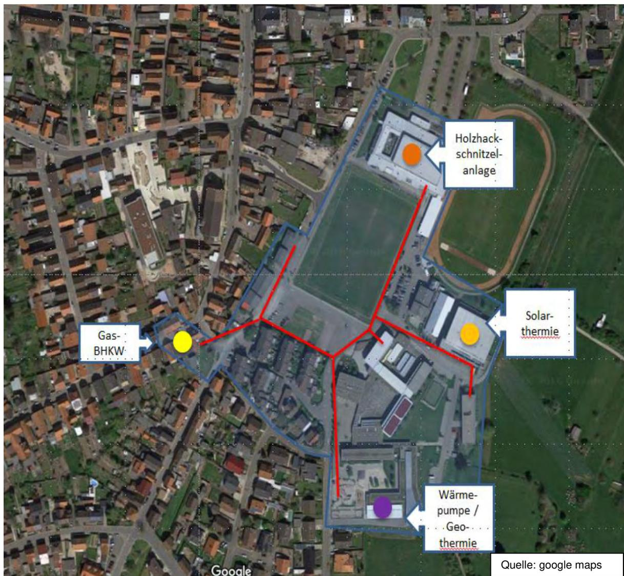
Abbildung: Möglicher Trassenverlauf der Nahwärmeversorgung im Quartier „Kronau“
