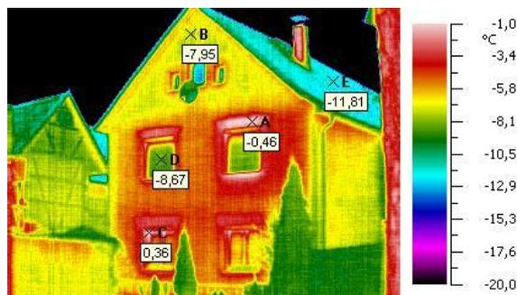
Abb. 4: Älteres Haus ohne ausreichende Wärmedämmung (Quelle: Lutz Weidner, <https://de.wikipedia.org/wiki/Energieausweis>)
